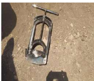
دستگاه گیوتین لوله بر مورد استفاده
