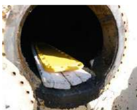
برآنگارده مورد استفاده جهت خارج کردن نفرات حادثه دیده
