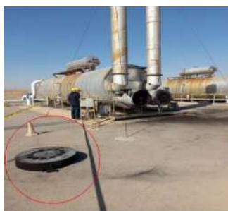
محل افتادن درب هیتر در اثر انفجار
