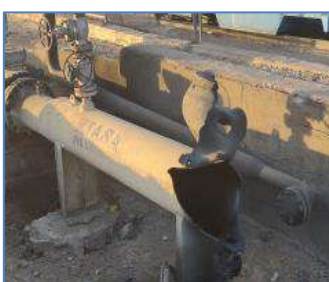
شکل ۲- محفظه ارسال توپک منفجر شده (ایستگاه A)
